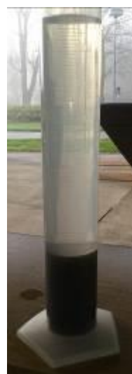
Odměrný válec po 30 min. sedimentace. Zřetelné rozhraní kalu a vody (zde např. nízká koncentrace kalu)
