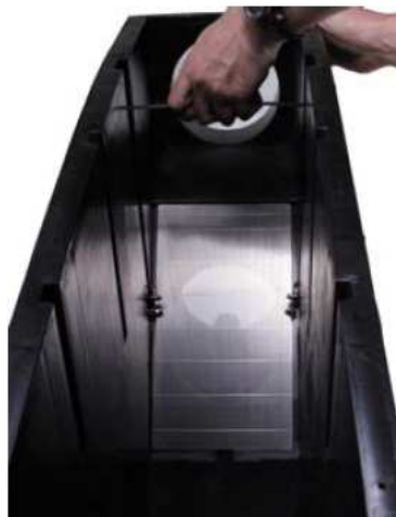
Obr. 30: Vyjmutí síta PR150
